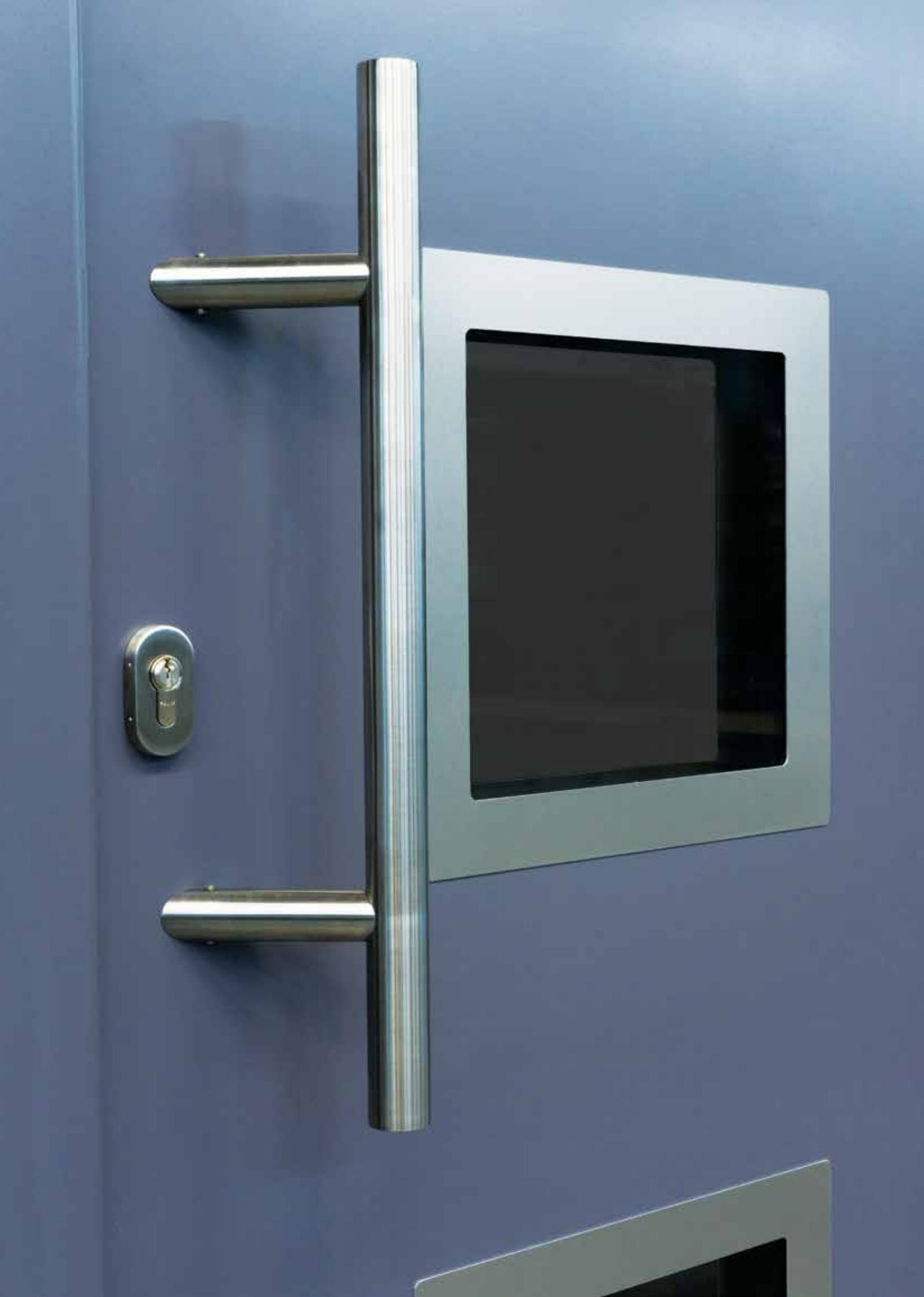
RD65 Le cadre est fait de composite de profile en aluminium avec rupture thermique d'épaisseur de 24 mm. Le vantail est d'épaisseur de 65 mm avec paroi de tôle en acier. Isolation thermique - mousse PU sans fréon.
