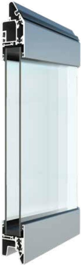
Les profils en aluminium avec rupture de pont thermique améliorent de manière significative la valeur d'isolation des panneaux de la porte sectionnelle panoramique. Les portes FV Thermo sont produites jusqu'à 7 mètres de large, 6 mètres de haut, avec double vitrage acrylique standard ou double vitrage Anti-rayures. En ce qui concerne les dimensions des portes possibles vitrées par double verre de sécurité – consultez à l'usine.
